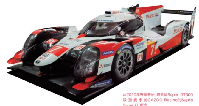
在碳纤维的车身上搭载了以2.4L发动机为中心的丰田油电混合动力系统(THS-R)的TS050 HYBRID。
